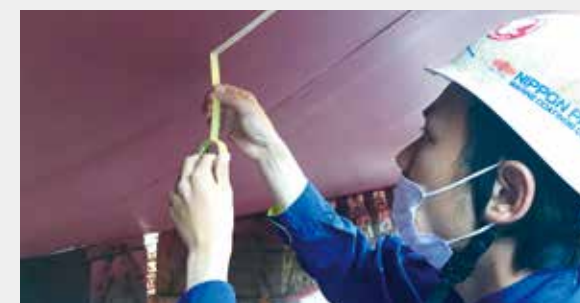
FASTARの塗膜状態を確認する日本ペイントマリンの技術者
